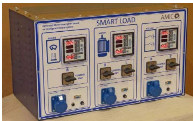
Banco di test progettato per collaudare le performance di InPower
