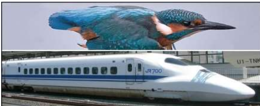
Fig. 5 Il profilo aerodinamico del treno Shinkansen ispirato al becco del Martin Pescatore (Fonte Ichi.pro)
