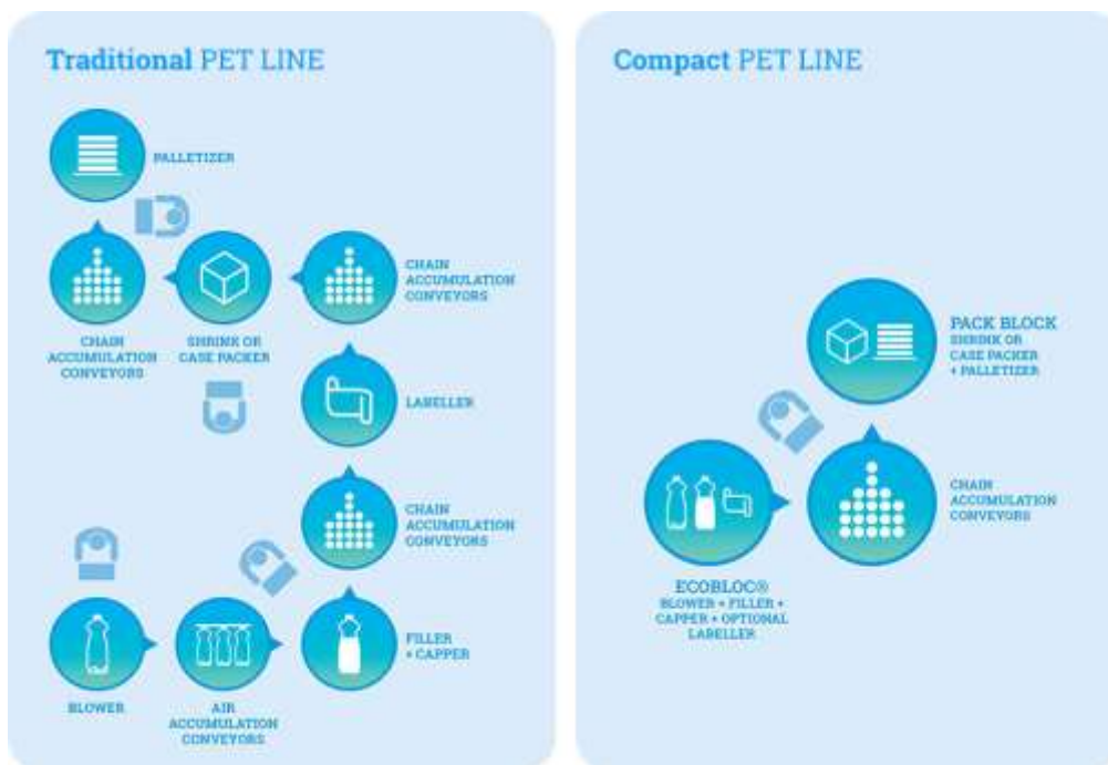
Fig. 9 Schema della nuova linea di produzione di contenitori in plastica. (Fonte: https://www.smigroup.it/ )
