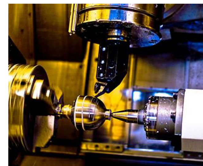
Centro di lavoro CNC 5 assi Integrato durante un'operazione di tornitura
