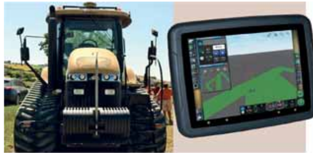
Guida semi-automatica, sistema RTK
